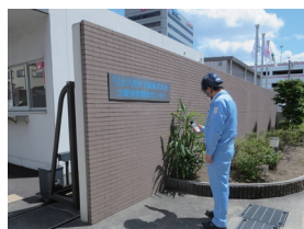
敷地境界線の騒音測定
